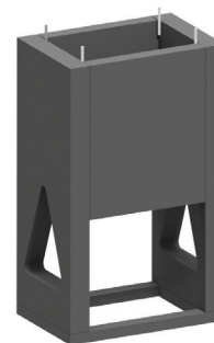
FZ - Fundament żelbetowy
